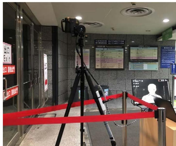
紅外線熱顯像測溫設備
