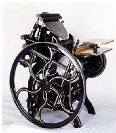
圖 4 印刷機修護後
