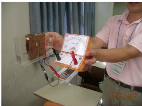
圖二十、氧化銅太陽能板電池( $\text{Cu}_2\text{O}$  Solar Cell)製作與測試
