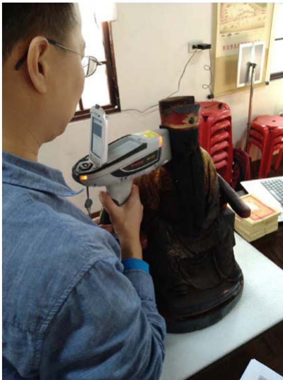
使用 XRF 分析儀進行神像臉部顏料成分檢測作業
