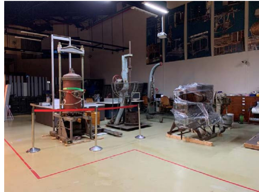
專為建造曾文水庫所用之大型三軸壓縮試驗儀
