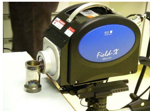
圖 9 運用 X 射線螢光能譜儀檢測量器現況
