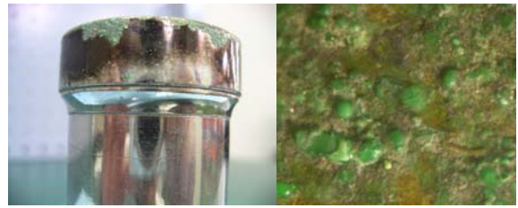
圖 8 綠銹光學顯微像，圓形的顆粒直徑大約 0.5mm[4]
