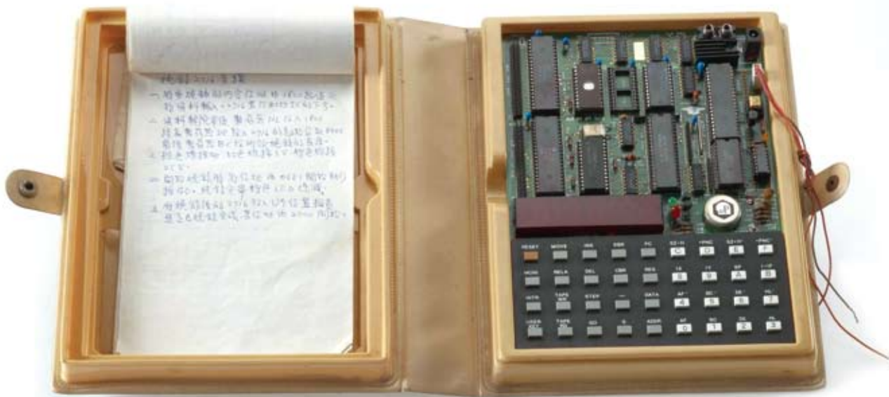
「小教授1號」的鍵盤內建在機體上，收納在塑膠外盒內。（圖片來源：國立科學工藝博物館）
