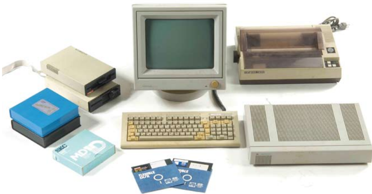
「小教授3號」是小教授系列的末代機種，擁有完整的介面，可連接印表機、錄音機、語音合成器等以擴充功能。 (圖片來源：國立科學工藝博物館)
