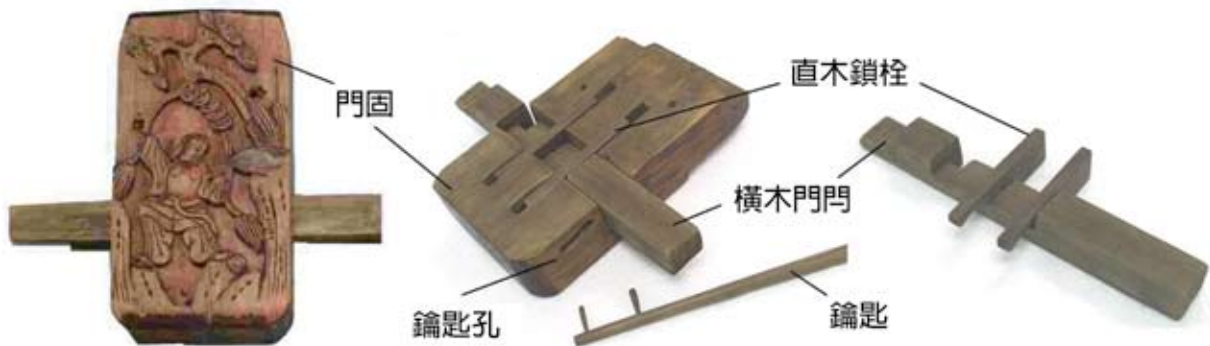
古中國木栓鎖包括雕花門固、橫木門門、直木鎖栓和鑰匙，構造原理和古埃及木栓鎖相似，不同之處在於鑰匙以旋轉方式提起直木鎖栓。
