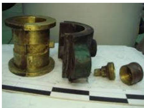
圖7 加注牛油支油壺 (拆解後圖，用柴油清潔油垢後，黃振中拍攝)
