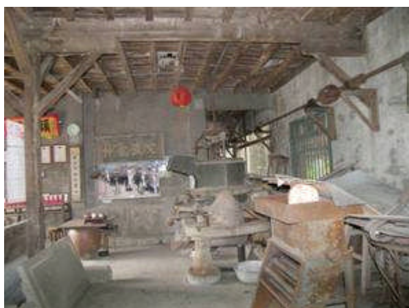
圖4 老茶廠一樓裡擺設數台製茶機器，牆面留有為帶動機器之長型軸承，運用
