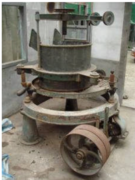
圖 1 當時從富興茶廠蒐藏之揉捻機圖，基座高度 80 公分由三個支撐腳所組成，
