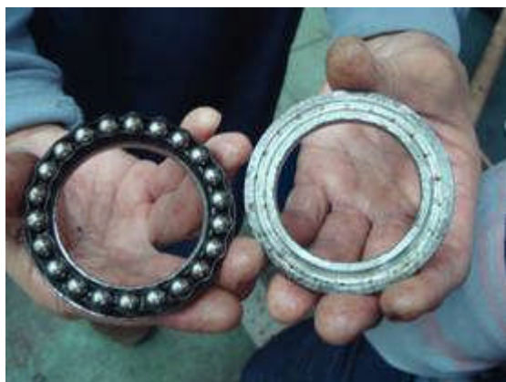
圖8 機器中一組滾珠軸承，使得揉捻順利推動之小公臣(黃振中拍攝)
