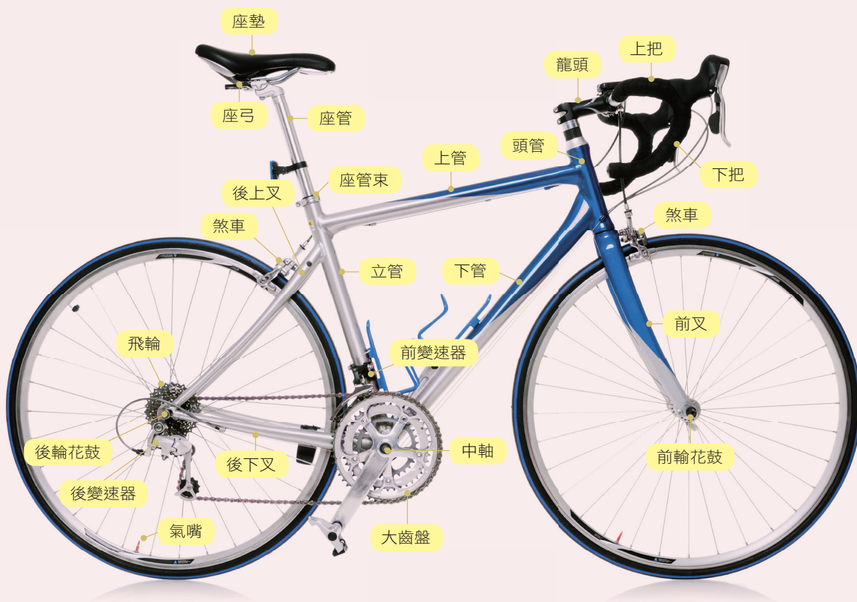
公路車的結構可概分為車架、操控與煞車、傳動與變速、輪組、座墊等幾大部分。(圖片來源：種子發)
