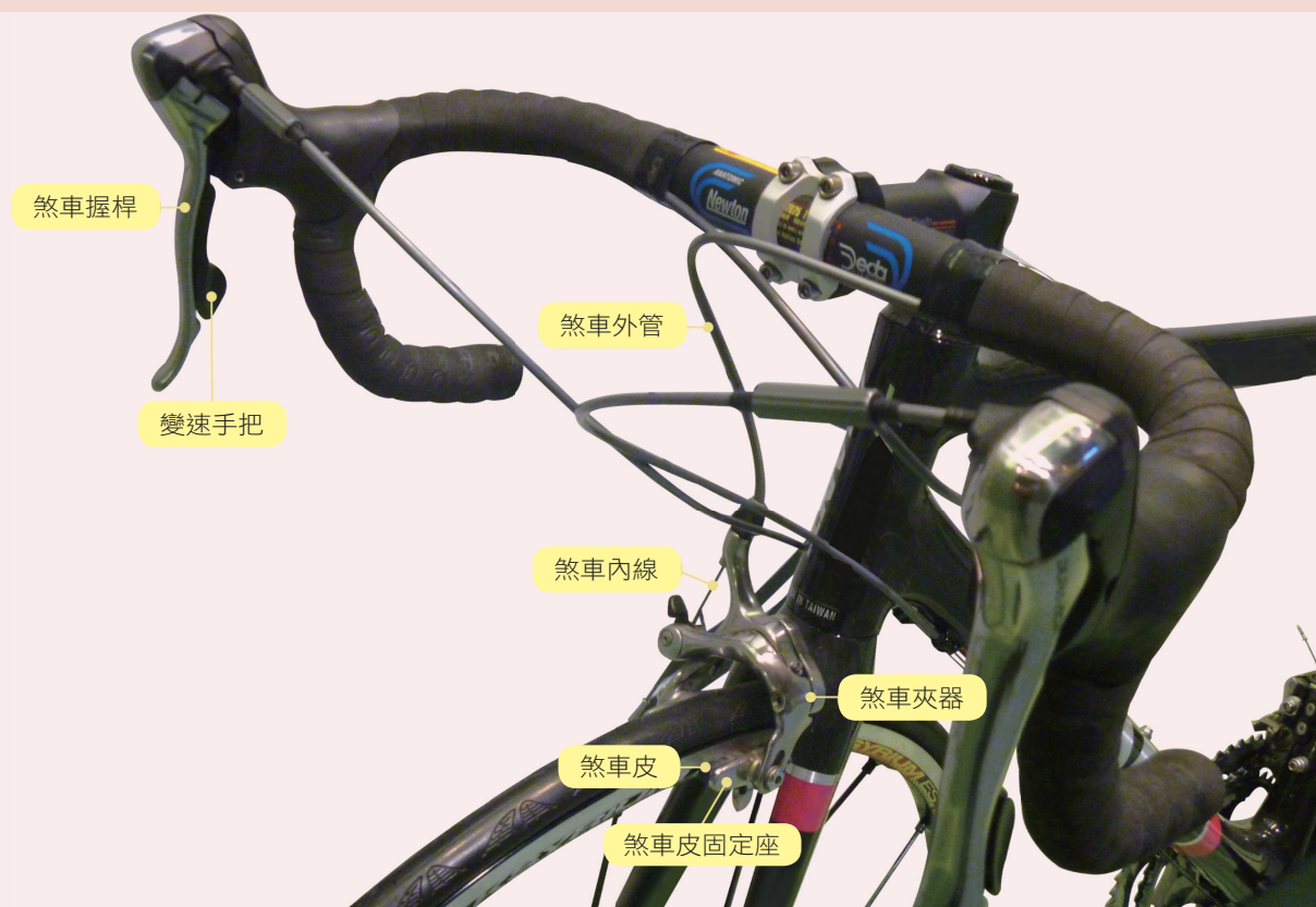
煞車構造圖。煞車系統是用來控制車速以達到減速或停車的目的，是可把動能轉換成摩擦熱的構造。
