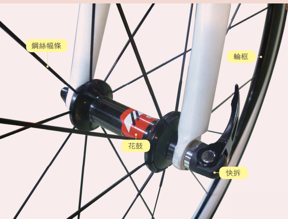
輪組一般由花鼓、鋼絲幅條、鋼絲頭、輪框、快拆、氣嘴及輪胎所組成。
