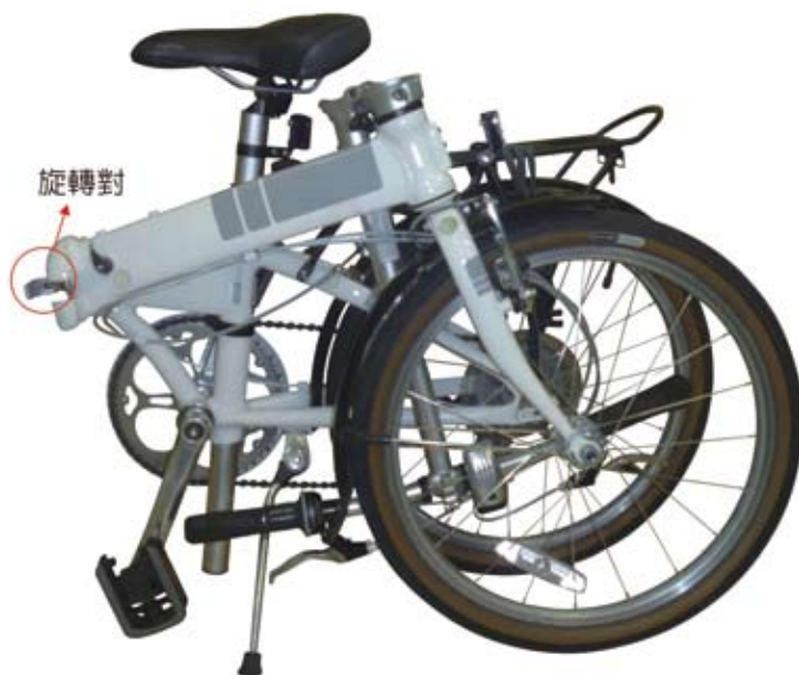
● 整車→立管（含把手）下旋→座桿（含座墊）向下旋轉和滑動→主車架旋轉折疊並把雙輪並行對疊→完成
