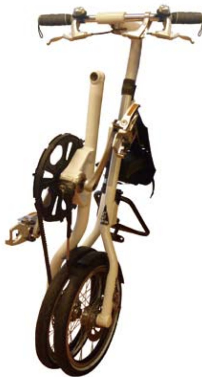
● 整車→鬆開下管把它提起放置一旁→前輪（連同前管）向座桿和後輪方向旋轉併攏→下管卡入前管和座桿的間隙→完成
