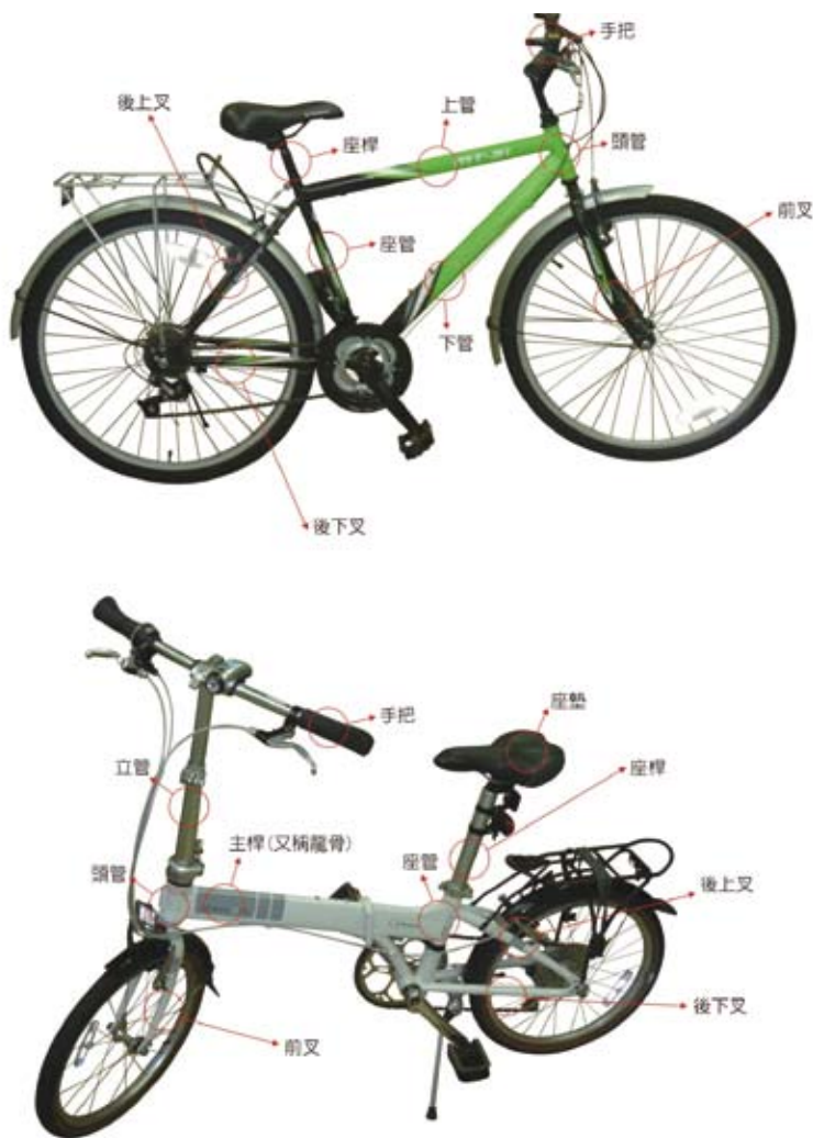
● 一般自行車和折疊車的構造對照
