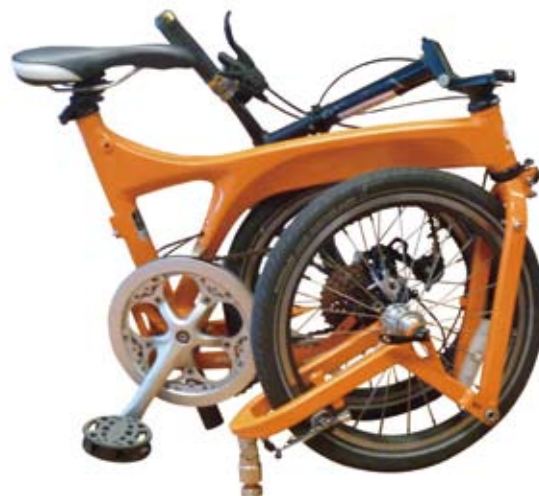
● 整車→前輪（連同前叉）往下往後向車架方向旋轉→後輪（連同後叉）往下往前向車架方向旋轉→座桿（含座墊）向下旋轉和滑動→立管（含手把）下旋→完成
