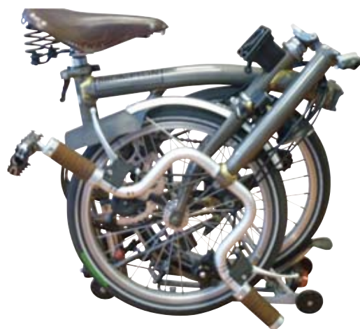
● 整車→後輪（連同後叉）往下往前向車架方向旋轉→前輪（連同前叉）由主車架旋轉折疊並把雙輪並行對疊→立管（含手把）下旋→座桿（含座墊）向下旋轉和滑動→完成
